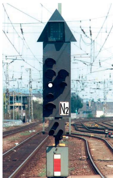
Abb. 5-42: Lichthauptsignal mit Kennlichtschaltung
