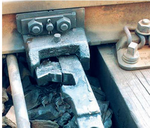
Abb. 2-51: Klammerspitzverschluss
