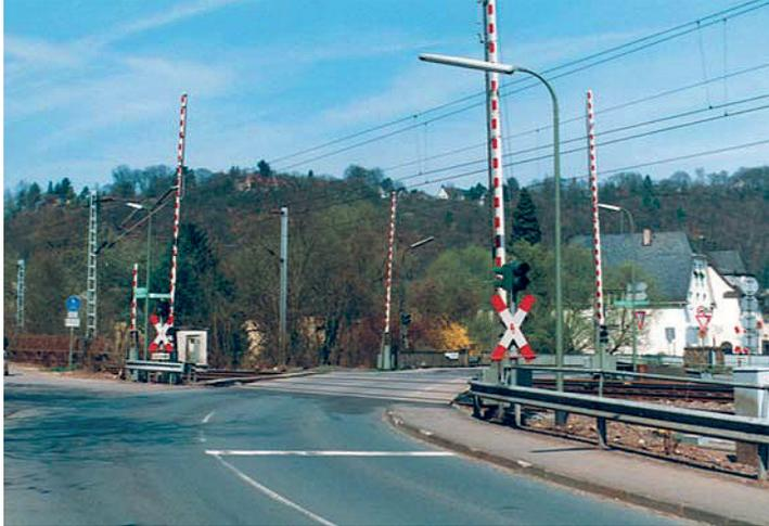
Abb. 8-8: Signalabhängige Bahnübergangssicherungsanlage mit Vollschranken
