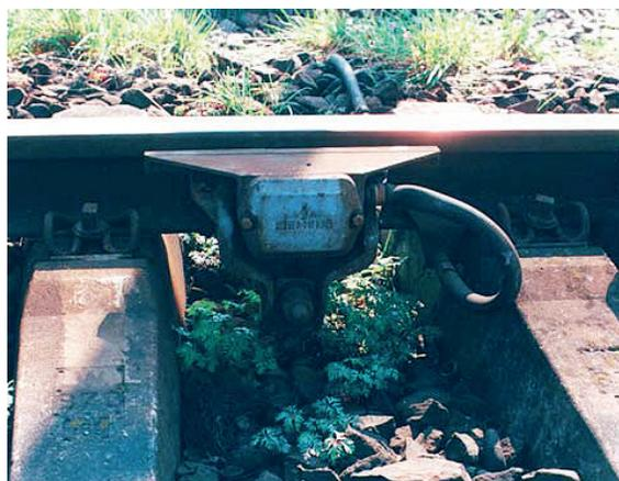
Abb. 2-61: Achszähler der Firma Siemens
