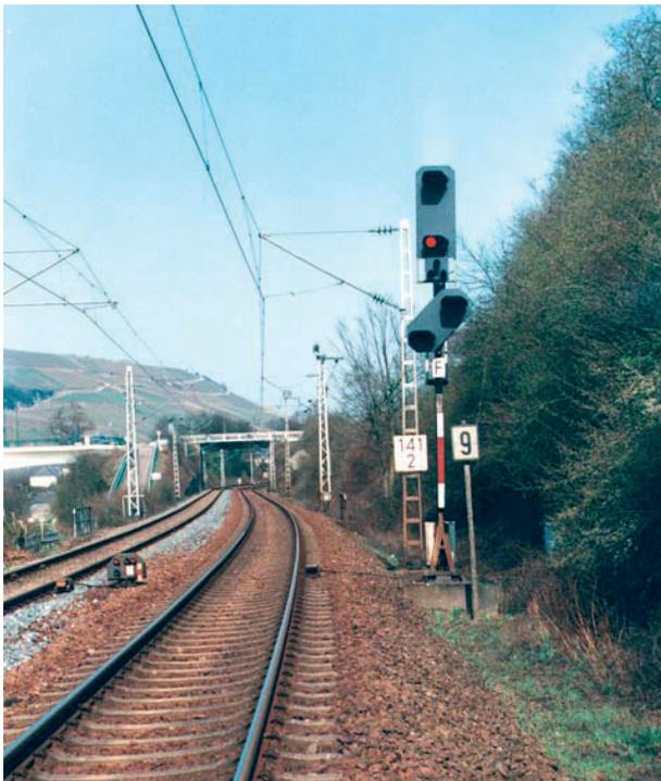
Abb. 2-22: Einfahrsignal als Lichthauptsignal
