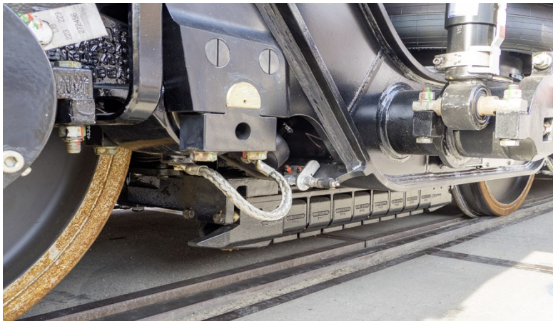
Abb. 2-4: Schienenbremsen wirken unmittelbar auf die Schiene – die Abbildung zeigt ein Drehgestell mit Mg-Bremse.
