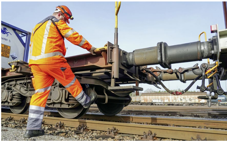
Abb. 9-4: Beim Feststellen des Brems- oder Lösezustands wird bei klotzgebremsten Fahrzeugen an jeder Achse geprüft, ob die Reibelemente anliegen bzw. gelöst sind. Foto: DB AG/Volker Emersleben
